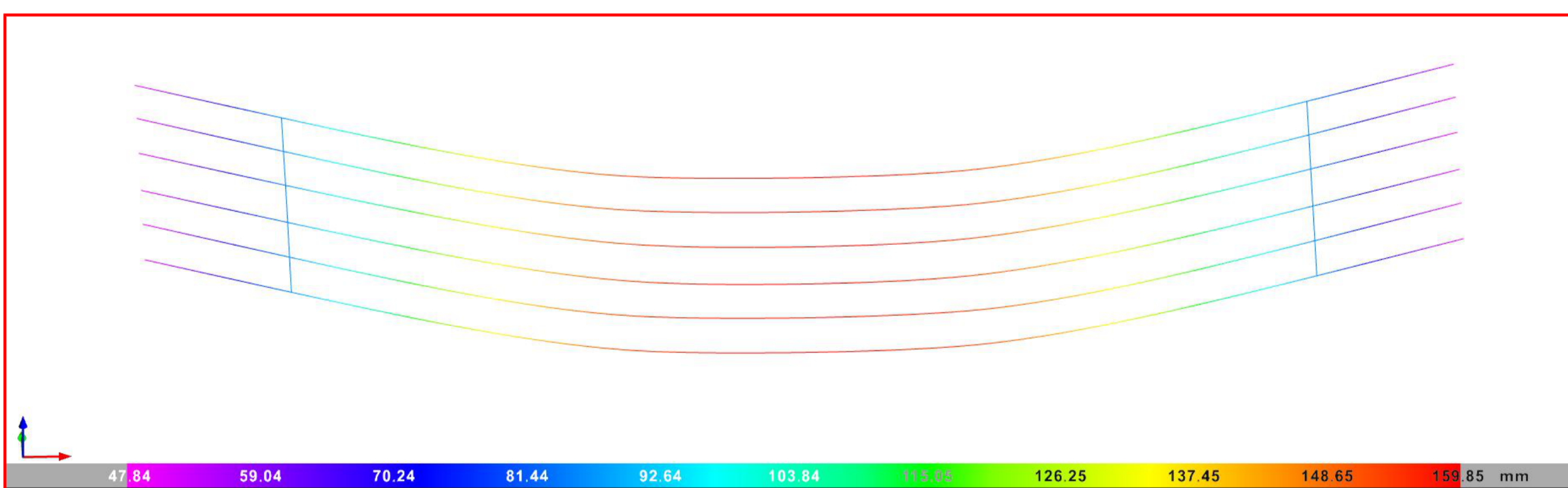
DEFORMACIÓN TEÓRICA DEL VARAL PARA TALLAJE DE PORTADORES Y PORTADORAS
